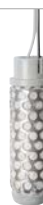
SC-PROBE Sonda sensore di umidità del terreno (opzionale) Altezza: 8,3 cm Diametro: 2,5 cm Lunghezza massima del cavo dal programmatore alla sonda: 30 m, cavo adatto all'interramento diretto da 1 mm 2
