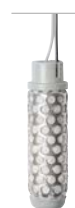
SC-PROBE Sonda com sensor de umidade do solo (opcional) Altura: 8,3 cm Diâmetro: 2,5 cm Controlador para a sonda: 30 m no máximo 1 fio subterrâneo de 1 mm 2
