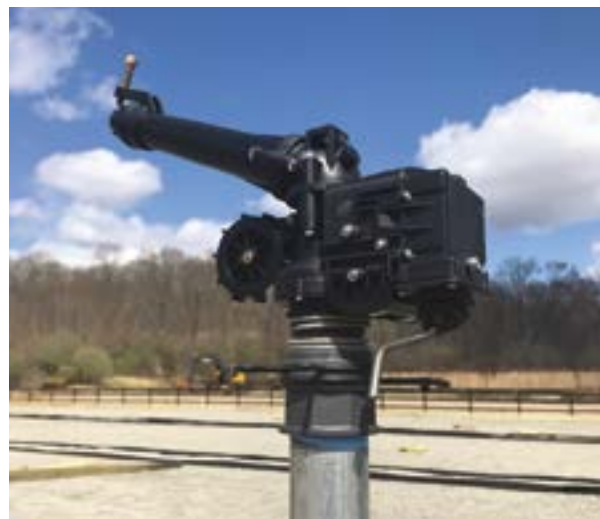
Εγκατεστημένος Ρότορας ST-1200-BR
